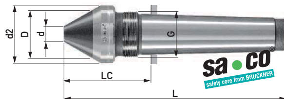
Form GZ großer Hartmetalleinsatz mit Sicherheitskern sa•co ®
