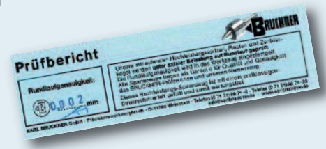
Prüftabelle „Rundlaufgenauigkeit“ am Beispiel Typ ZA, ZAG
