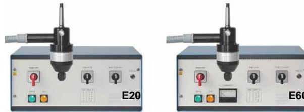
Das Erodieren erfolgt durch Lichtbogen-Erosion, in Verbindung mit unserer speziellen Steuerung bietet sich ein bisher unerreichter Bedienkomfort, ein schnelles Erodieren, eine hohe Leistungsfähigkeit und eine lange Einschaltdauer gegenüber herkömmlichen Geräten. Die Erodierspannungen liegen unter 25V dadurch sind sie, selbst bei Berührung, ungefährlich.
