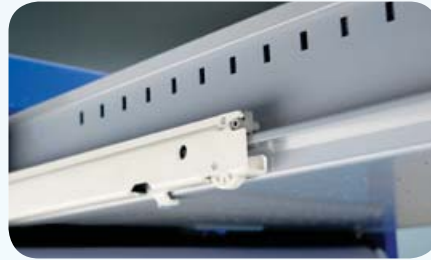
Traversenlos geführter Differenzialauszug inklusive Aushebesicherung = leichtgängig, leise und sicher.
