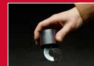
Wiederholung – Abkoppeln vom Werkzeug, der Rohling fällt leicht heraus – erneut bearbeiten
