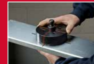
Fadenkreuz zur Ausrichtung auf dem Werkstück
